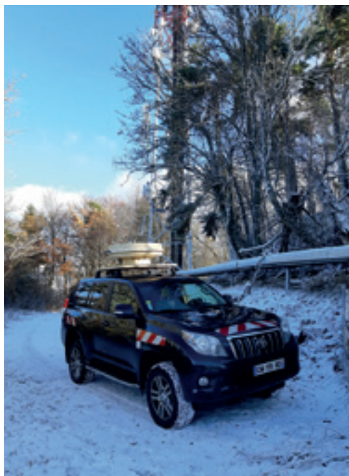
Véhicule technique 4x4 équipé d'un radiogoniomètre à des fins de recherche technique et de localisation d'émetteurs, dans un contexte notamment de résolution de brouillage. © ANFR
