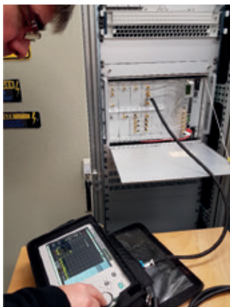
Mesures spectrales pour le traitement d'un brouillage. ©ANFR
