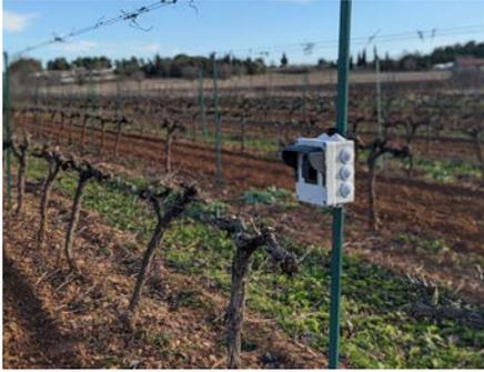
parcelle si ce qu'il constate sur l'image pose question. La construction d'une Agrocams coûte 100 € et un abonnement 4G est nécessaire. Afin d'éviter les salissures liées aux traitements (biologiques ou conventionnels), l'objectif de l'Agrocams est muni d'un couvercle protecteur qui s'ouvre uniquement le temps de la prise d'une image.
