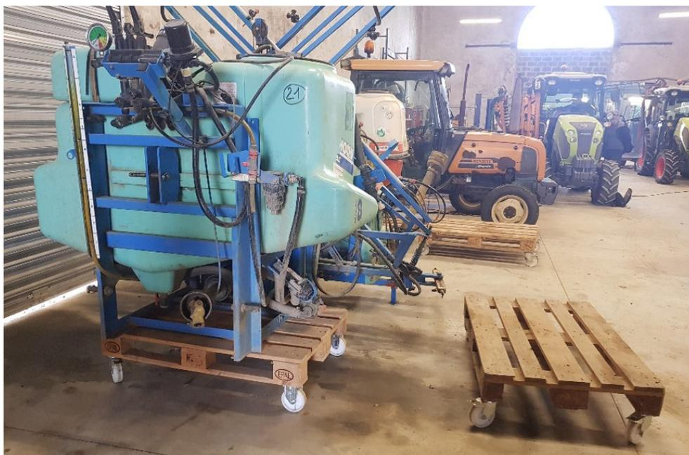
Figure 1. Illustration d'un système auto-fabriqu      partir de palettes et de roulettes.
