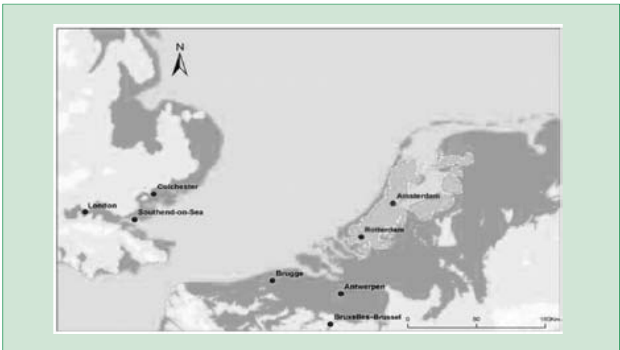
Figure 3. En foncé, zone actuellement sous le niveau moyen de la mer. Sans tenir compte de la hausse globale du niveau des mers, le niveau maximal atteint environ une fois par an (en moyenne) suite aux marées et tempêtes est de 5,5 m en Belgique, et environ 7 m tous les 1 000 ans. De larges zones sont sous ce niveau et donc protégées des inondations (Giec).
