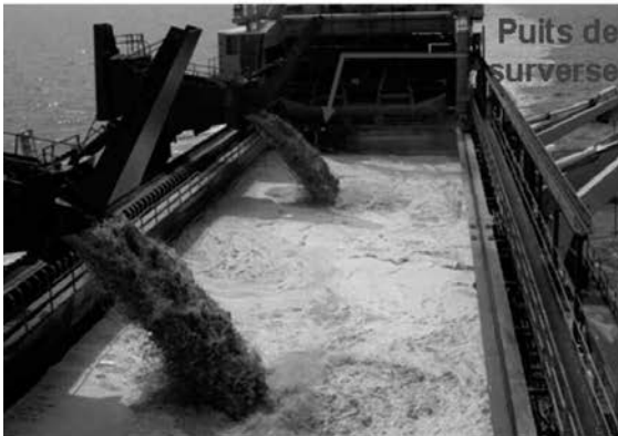
Figure 2 : Principe de l'extraction en marche de granulats marins à l'aide d'une drague aspiratrice.
