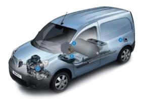
a) Chaîne de traction d'un véhicule léger (13).
