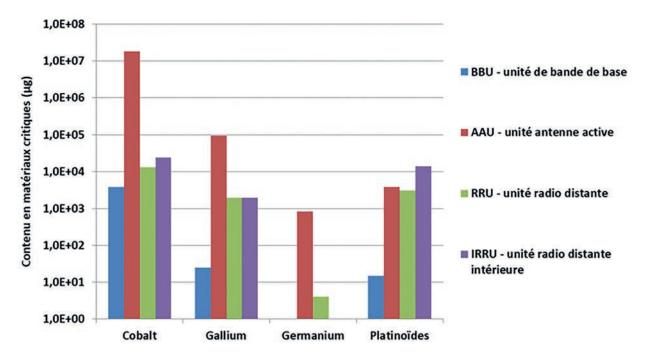
Figure 6 : Sélection de 4 matériaux critiques contenus dans 4 équipements réseaux différents (source : Orange -Travaux OLN/GDM).
