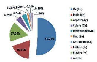
Figure 4 : Contribution des différents matériaux à l'élaboration de l'indicateur ARD (source : Orange Travaux OLN/GDM).
