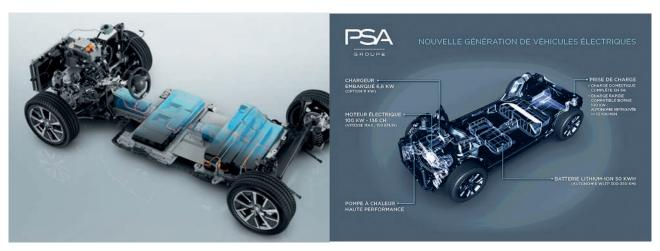
Figure 5 : Architecture électrique de la plateforme e-CMP du Groupe PSA (11).
