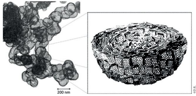
Figure 5 : Image obtenue par microscopie électronique à transmission (TEM) d'un agrégat de noir de carbone caractéristique et représentation schématique de la section d'une particule primaire.
