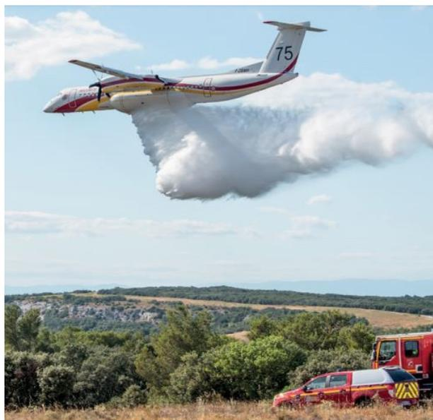
Photo 7 : Bombardier d'eau de type Dash – Source : Photo©Ministère de l'Intérieur – Direction générale de la Sécurité civile et de la Gestion des crises (DGSCGC).
