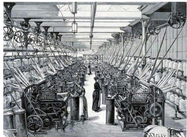
Figure 13 : Une usine textile équipée de nombreuses machines électriques. Ces diverses machines sont mises en mouvement par l'intermédiaire d'un système complexe d'arbres et de courroies, alimenté à partir d'un moteur à vapeur, qui constitue la source d'énergie principale – Source : Wikipedia.
