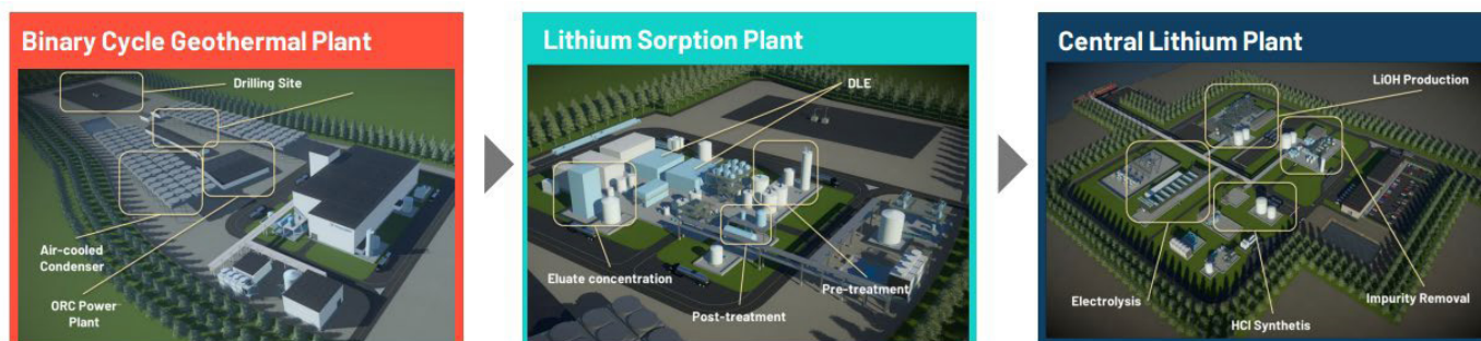
Figure 5 : Schéma de principe du projet de Vulcan ; à gauche centrale géothermique, au milieu atelier d'extraction de lithium, à droite usine finale (Source : étude de faisabilité de la phase 1, février 2023).
