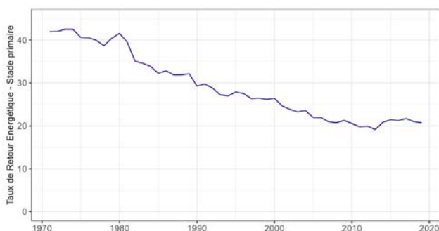
Figure 2. Taux de retour énergétique moyen, au stade primaire, du pétrole et du gaz au niveau mondial (1971-2019) (Source : Aramendia et al. , 2023).
