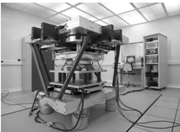
Figure 1 : Instrument de mesure nanométrique de référence du LNE combinant la technologie AFM sur un volume 300mm x 300mm x 50 \mu\text{m} , dans une salle blanche à environnement stable et contrôlé. Tous les déplacements en X, Y, Z sont traçables au système international des unités par interférométrie laser. Photo, par autorisation de S. Ducourtieux et F. Larsonnier (LNE, laboratoire de nano-métrieologie dimensionnelle).
