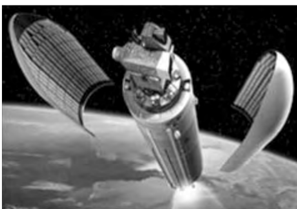
Photo 4 : Le satellite Hélios mis en orbite par le lanceur Ariane 5 (représenté ici juste après le largage de sa coque de protection).
