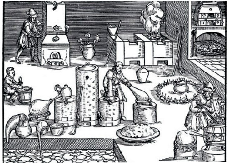
Figure 2 : Un atelier d'essayeur à la fin du XVI e siècle publié dans Thomas et al. (2006), d'après Lazarus Ercker (1580). Dans le fond, à droite, un four de coupellation est visible.
