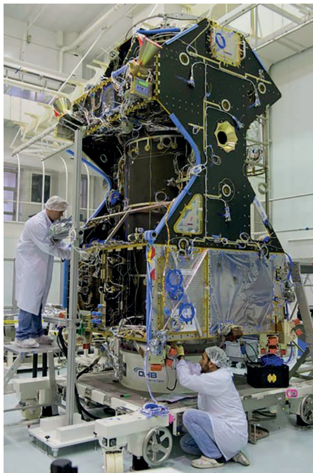
Photo 5 : Intégration chez OHB du module Trace Gas Orbiter de la mission Exomars.
