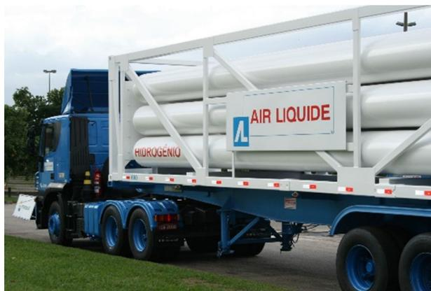
Figure 5 : Acheminement de l'hydrogène gazeux par semi-remorque.
