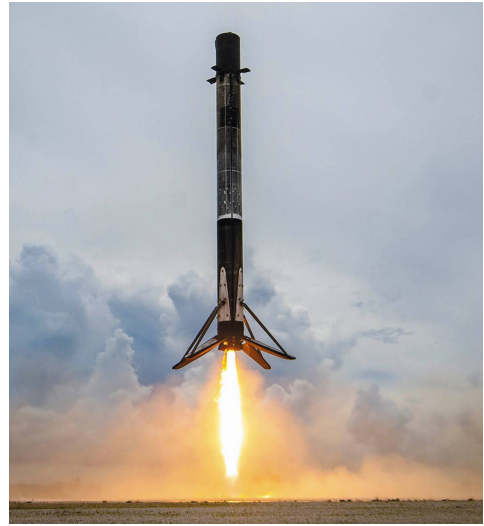
Figure 5 : Falcon 9 : retour du premier étage (© SpaceX).
