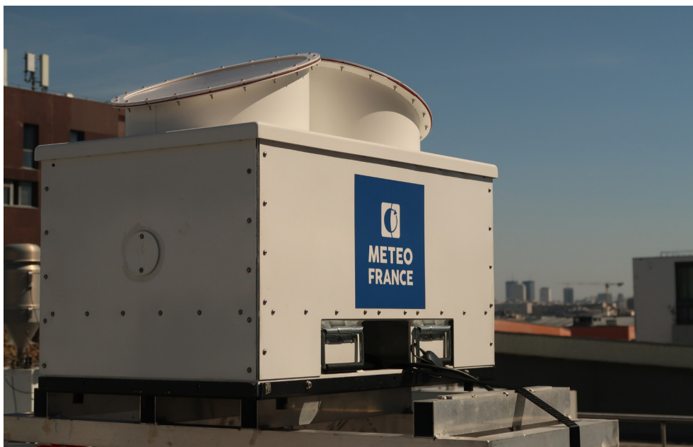
Figure 7 : Radar à 95 GHz permettant d'étudier les propriétés physiques des nuages, en particulier en conditions orageuses (Source : Météo-France).
