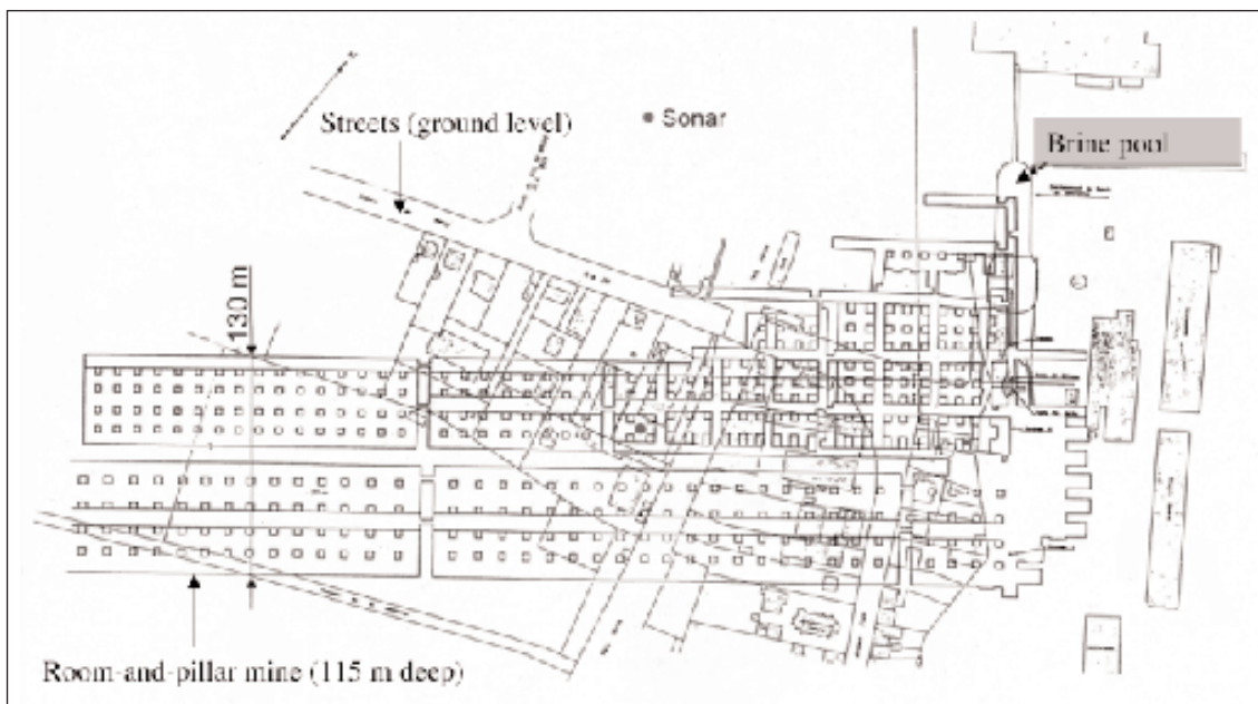
Mine de Dieuze (Lorraine). On a superposé sur ce plan : la mine de sel exploitée par chambres et piliers à 115 m de profondeur ; la galerie qui contenait une réserve de saumure, à 60 m de profondeur ; le niveau de la rue. La galerie, puis la mine, ont été envahies par de la saumure en 1864. Un sondage complété par une mesure sonar a été effectué en 2002 par Geoderis pour reconnaître l'état actuel de la mine.
