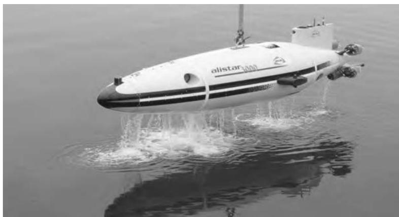
Photo 4 : l'Alistar-3000, AUV d'inspection (utilisable jusqu'à 3 000 m de fond)
