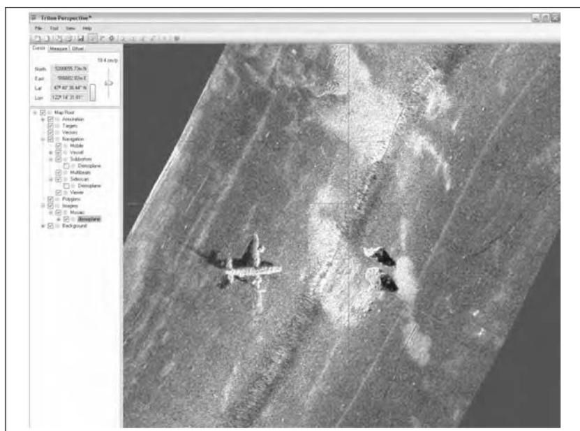
**Photo 5 :** Image d'une épave d'avion obtenue par post-traitement de signaux sonar
