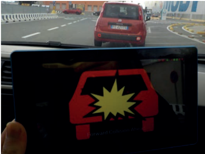
Figure 4 : Avertissement de risque de collision
