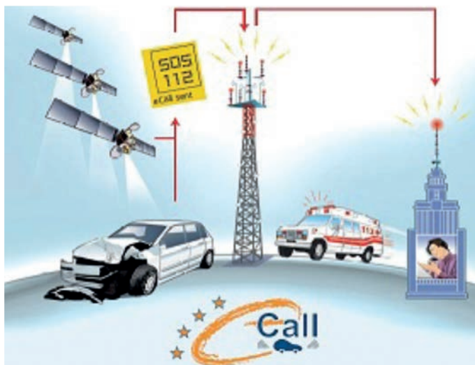
Figure 3 : Le système eCall, d'après (CE-eCall, 2018).
