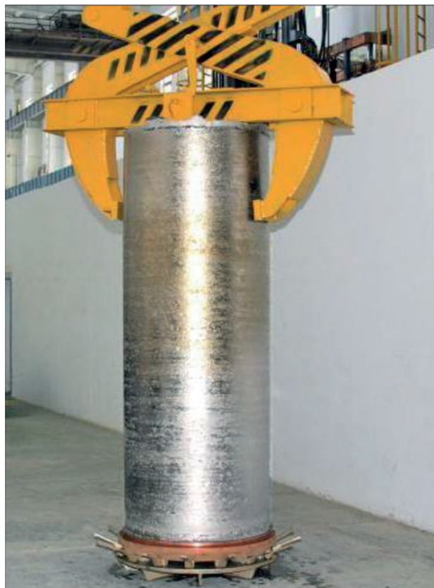
L'un des premiers lingots de titane produit au Kazakhstan, société UKTMP.
