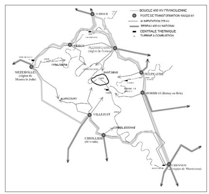
Fig. 1. - L'alimentation de l'Île-de-France est directement assurée depuis une « boucle » 400 000 Volts : cette structure en boucle a pour but de garantir la région parisienne contre une coupure généralisée d'alimentation.
