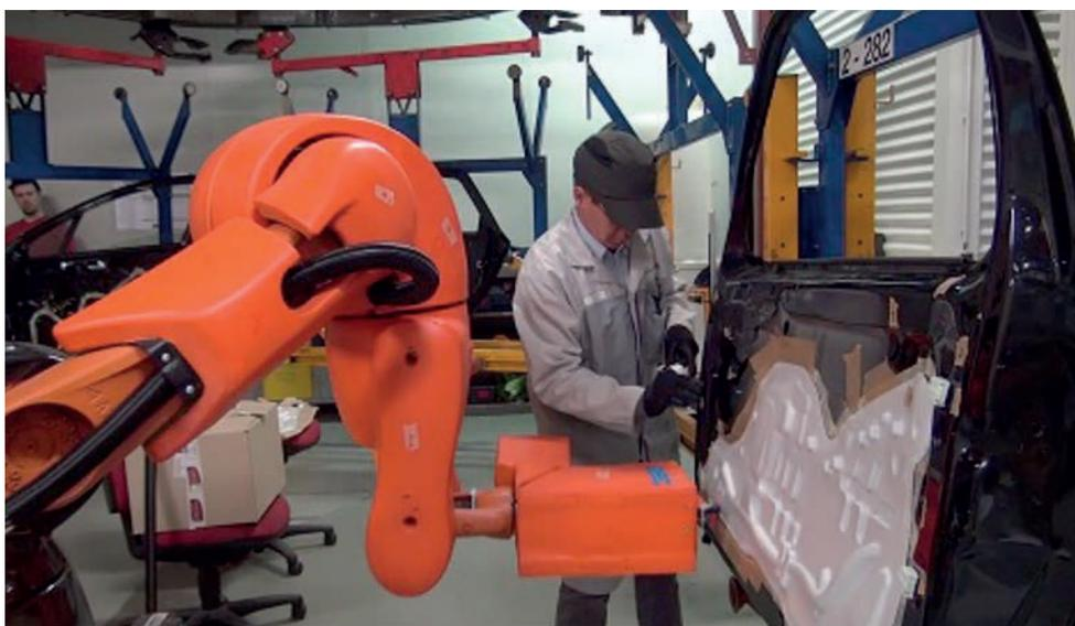
Figure 1 : Montage de porte en « co-présence » avec un robot (Weistroffer, 2014).
