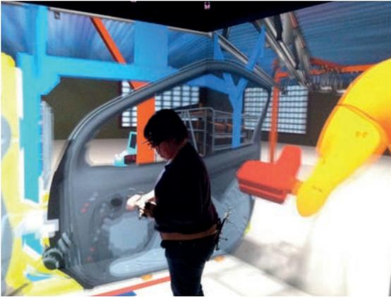
Figure 6 : Utilisation de la réalité virtuelle pour la simulation d'un poste de travail avec un robot collaboratif. L'opérateur interagit ici dans un système immersif à trois faces (Weistroffer, 2014).
