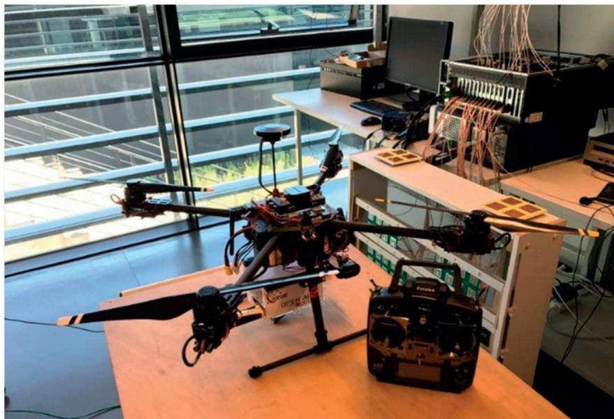
Figure 1 : Station de base cellulaire volante. Le prototype, développé en France par Eurecom, peut assurer une extension de connectivité. Il peut aussi servir de capteur autonome pour la localisation des nœuds terrestres.
