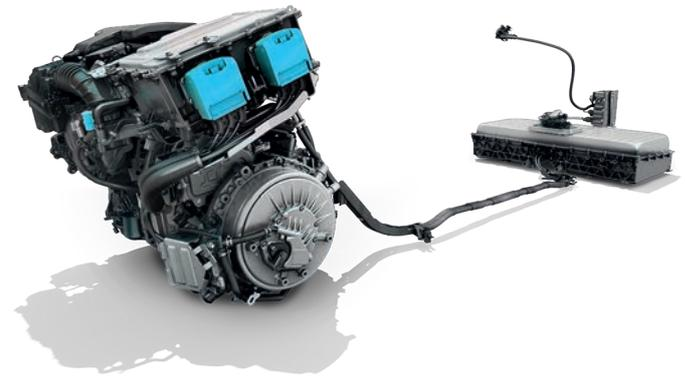
Figure 6 : Groupe moto propulseur hybride du Renault Captur E-TECH Plug-in<sup>(12)</sup> (source : ©Groupe Renault, direction de la communication).
