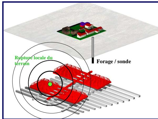
Figure 3 - Principe de fonctionnement d'une station d'écoute micro-sismique.
