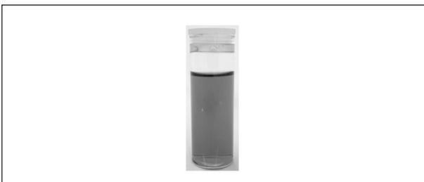
Photo 3 : Une solution colloïdale d'or nanométrique est de couleur rouge.
