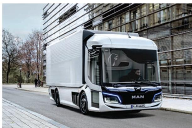
Figure 1 : Camion électrique e-TGM de 26 t de PTAC – Source : MAN (Group Volkswagen).
