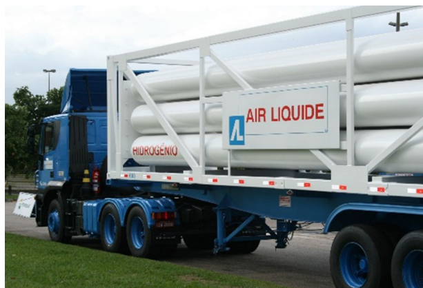
Figure 5 : Acheminement de l'hydrogène gazeux par semi-remorque.
