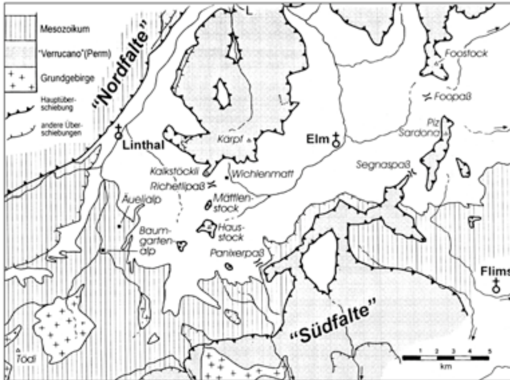
Fig. 7. Carte géologique simplifiée des Alpes de Glaris. Grundgebirge : socle de l'Aar ; Alttertiär : Tertiaire ancien (en blanc) ; Hauptüberschiebung : chevauchement principal de la nappe de Glaris (s.l.) ; Andere Überschiebungen : autres chevauchements ; Nordfalte, Südfalte : plis N et S, selon Heim, 1878) [Extrait de R. Trümpy & R. Oberhauser (1999)].
