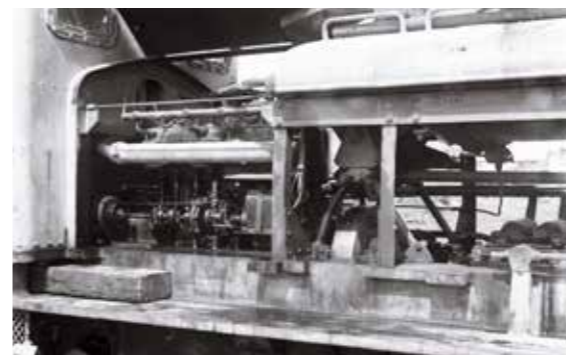
Capots ouverts, on distingue, de gauche à droite, le moteur, le volant d'inertie surmonté de la sablière et le dessus de la boîte de vitesse.
