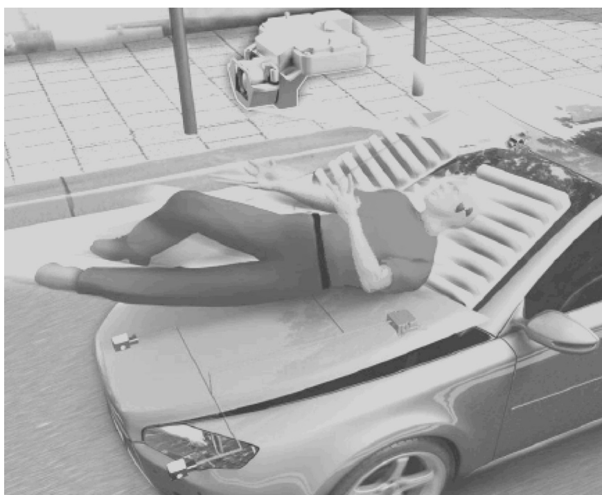
Illustration 4 : Déclenchement d'un airbag frontal, en cas de renversement inévitable d'un piéton.
