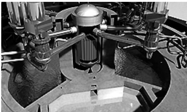
Zone de rétention du corium.
