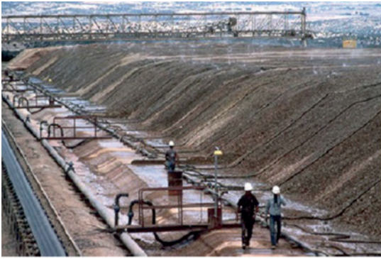
Figure 7 : À gauche : exemple de lixiviation en tas. À droite : des cuves de cyanuration et utilisation du procédé d'adsorption sur charbons actifs.
