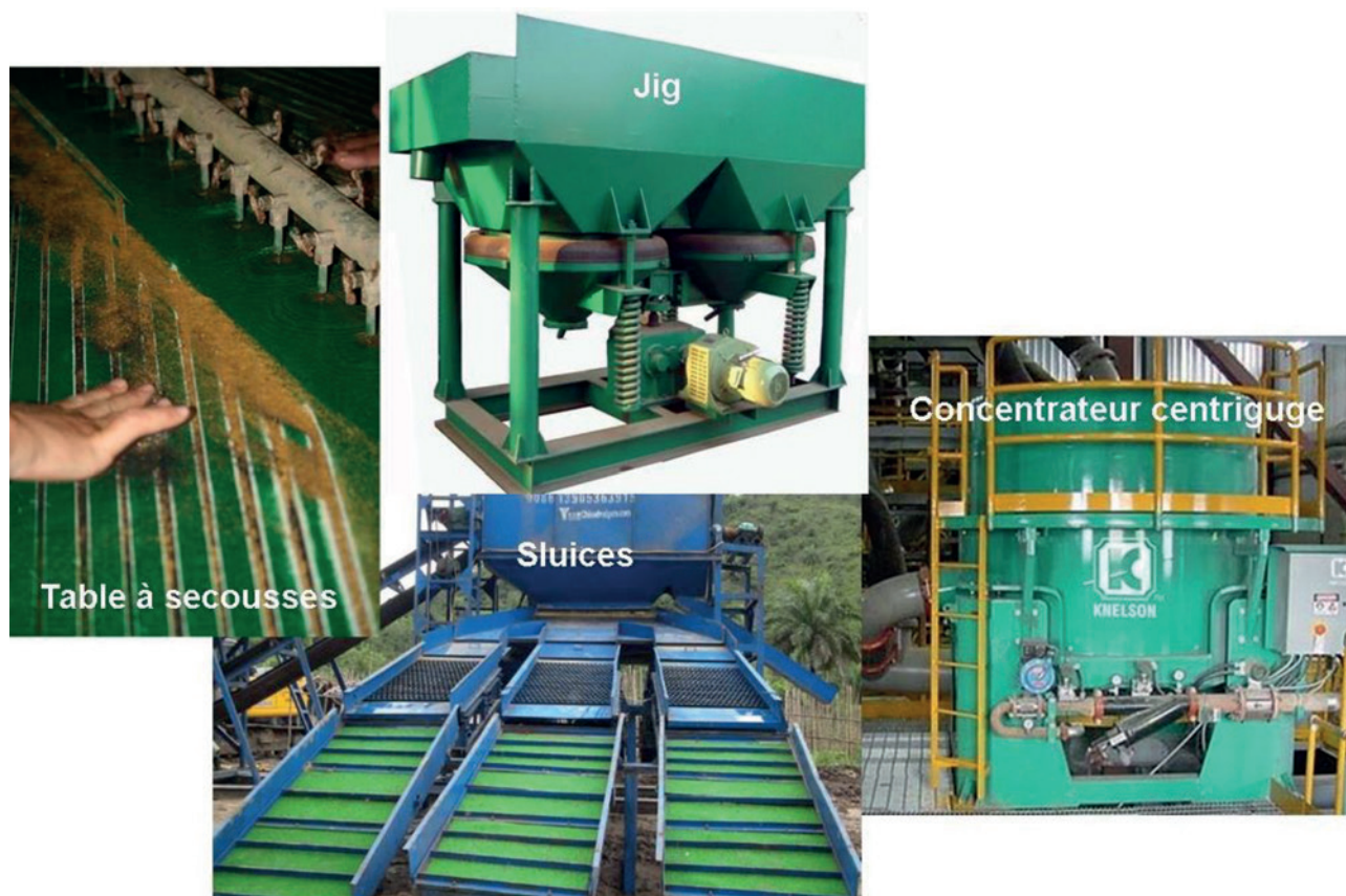
Figure 5 : Quelques exemples de matériels utilisés pour procéder au traitement gravimétrique des minerais d'or.
