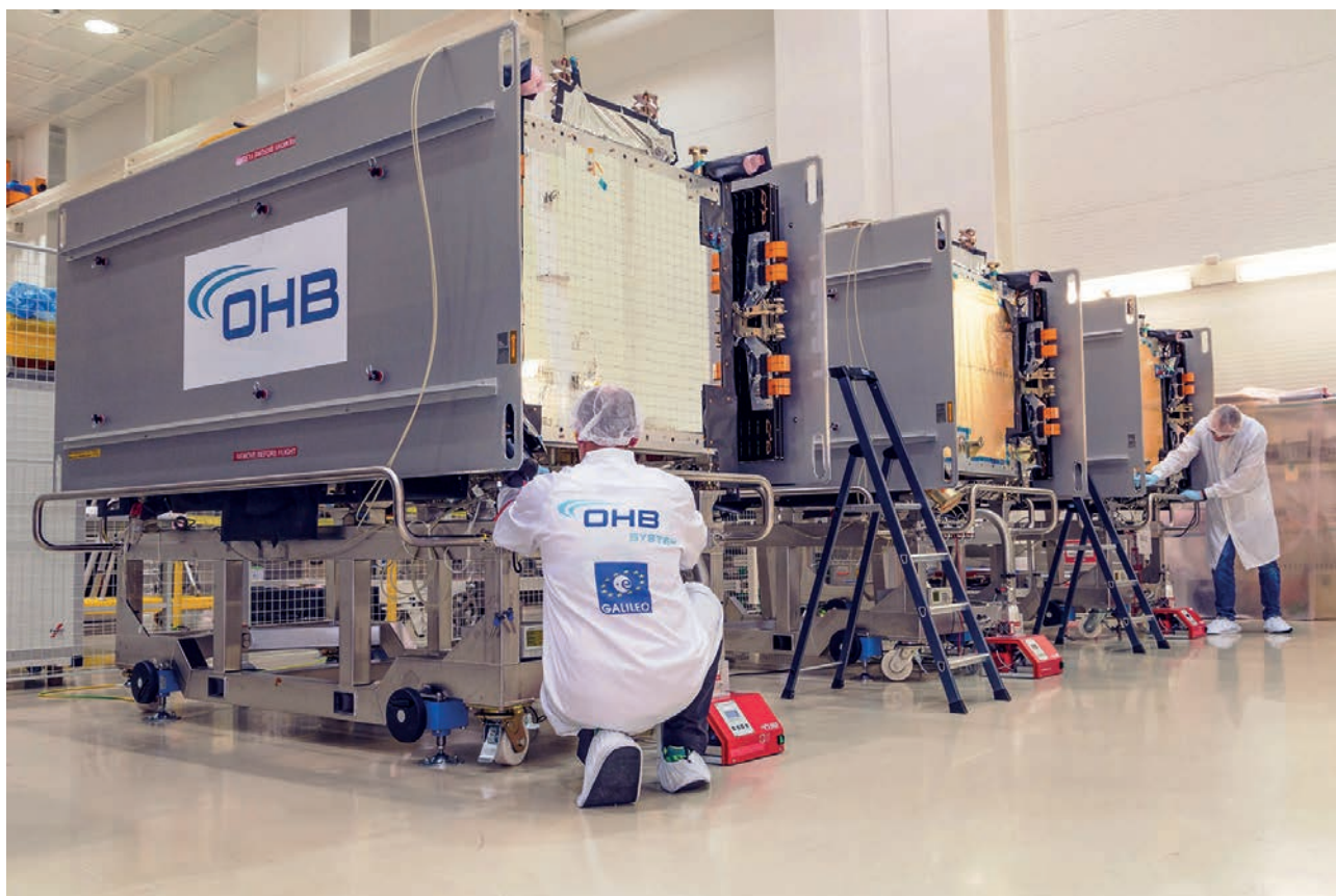
Photo 1 : Intégration en série de satellites Galileo.
