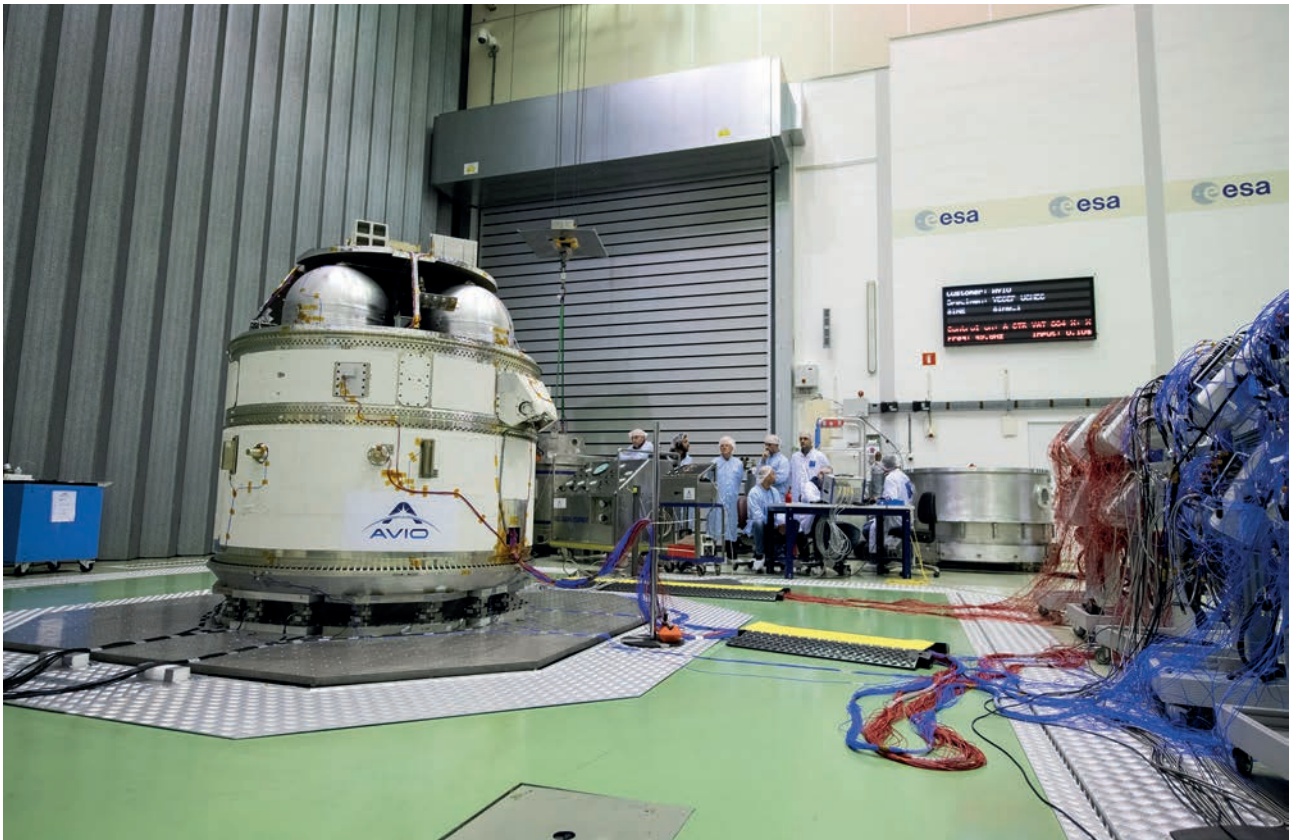
L'étage supérieur du lanceur Vega-C, lors d'essais au Centre européen de l'ESTEC.
