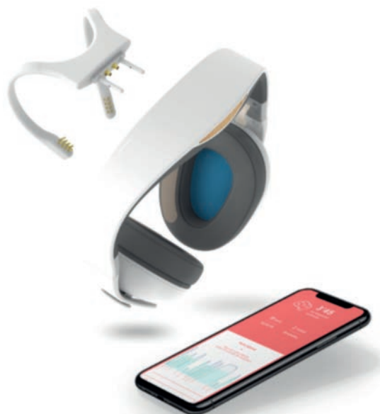
Figure 2 : Solution de neurofeedback Melomind, qui se compose d'un casque EEG-audio bluetooth et d'un programme d'entraînement cérébral matérialisé par une application mobile sur smartphone – ©MyBrain Technologies.
