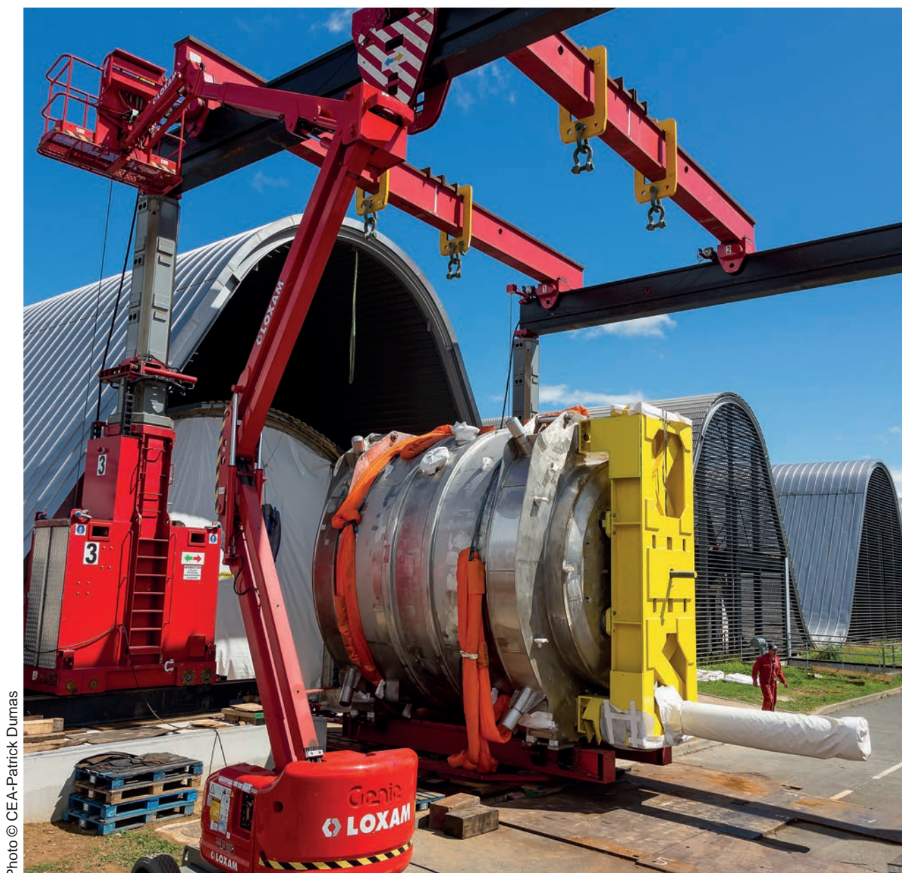
Figure 1 : L'aimant Iseult 11,7 T de 130 tonnes lors de son arrivée à l'Institut Neurospin.
