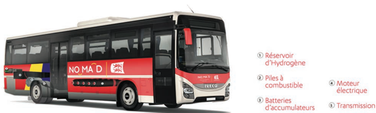
Figure 3 : Schéma initial d'implantation du kit hydrogène sur un IVECO Crossway (photo©Région Normandie).
